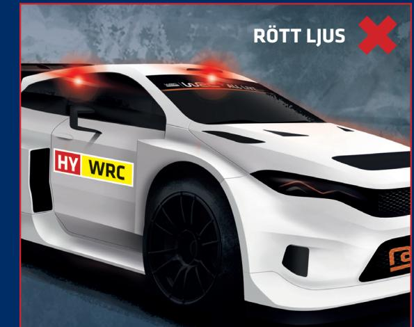
**3** Blinkande rött ljus, kombinerat med varningssirén, betyder att bilen är osäker. Inget ljus betyder att bilen kan vara osäker. Rör endast bilen om grönt ljus lyser.
